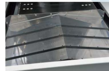
従来のテレスコピカバーの欠点を解消するパンタグラフ方式新構造のカバーを採用。
